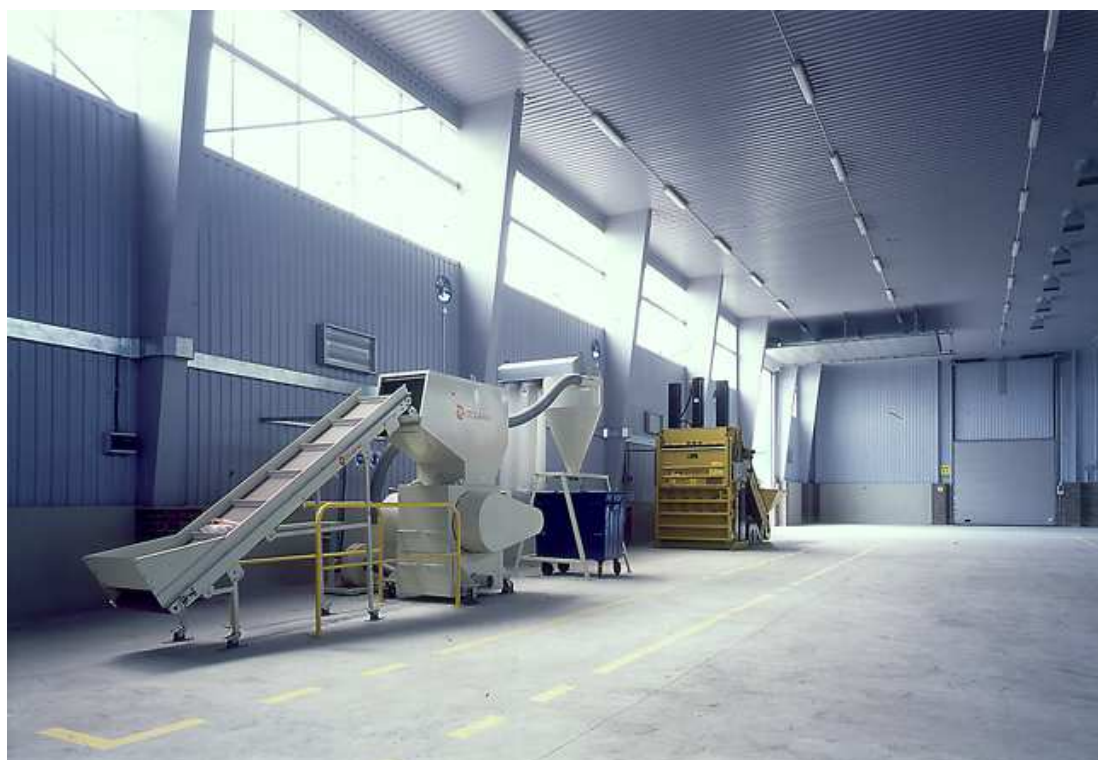
Rysunek 7 Hala sortowni wyposażona w granulator tworzyw sztucznych oraz belownicę pionową
