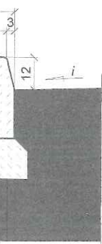
Krawężnik betonowy A 20x30x100 Ława betonowa B-15
