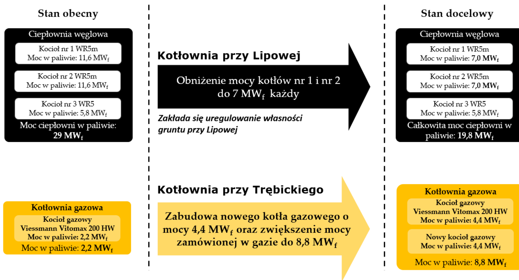
Rysunek 6.2.1 Schemat modernizacji systemu ciepłowniczego - Wariant I
